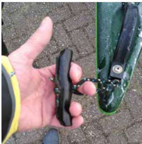
afknelgevaar bij niet samengebonden toggle
